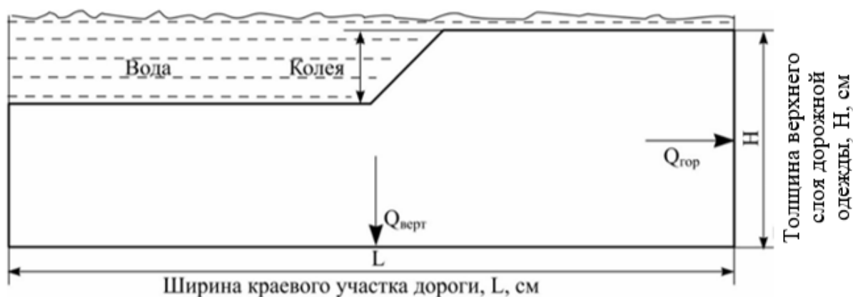
Рисунок 1 – Схема распределения потоков воды в полосе дорожного покрытия на краевом участке с колеей
