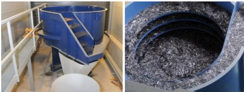
Рисунок Г.2 – Дозатор для подачи фибры в бетоносмеситель
