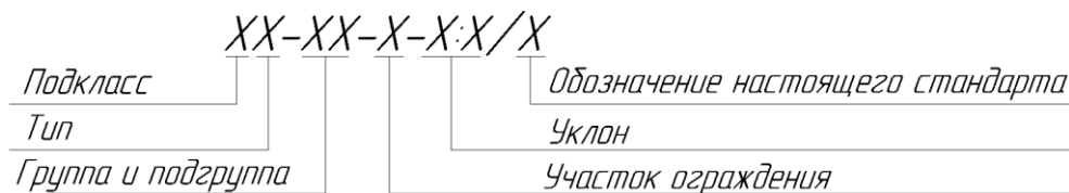
Рисунок 4.4 – Маркировка начального (конечного) и переходного участка ограждений
