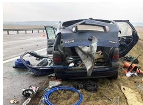
Рисунок Д.15 – Повреждения легкового автомобиля при наезде на торец барьерного ограждения
