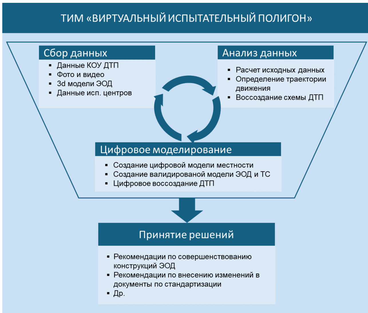
Рисунок 2 – Функциональная схема системы сбора и анализа данных о ДТП с наездом на ЭОД
