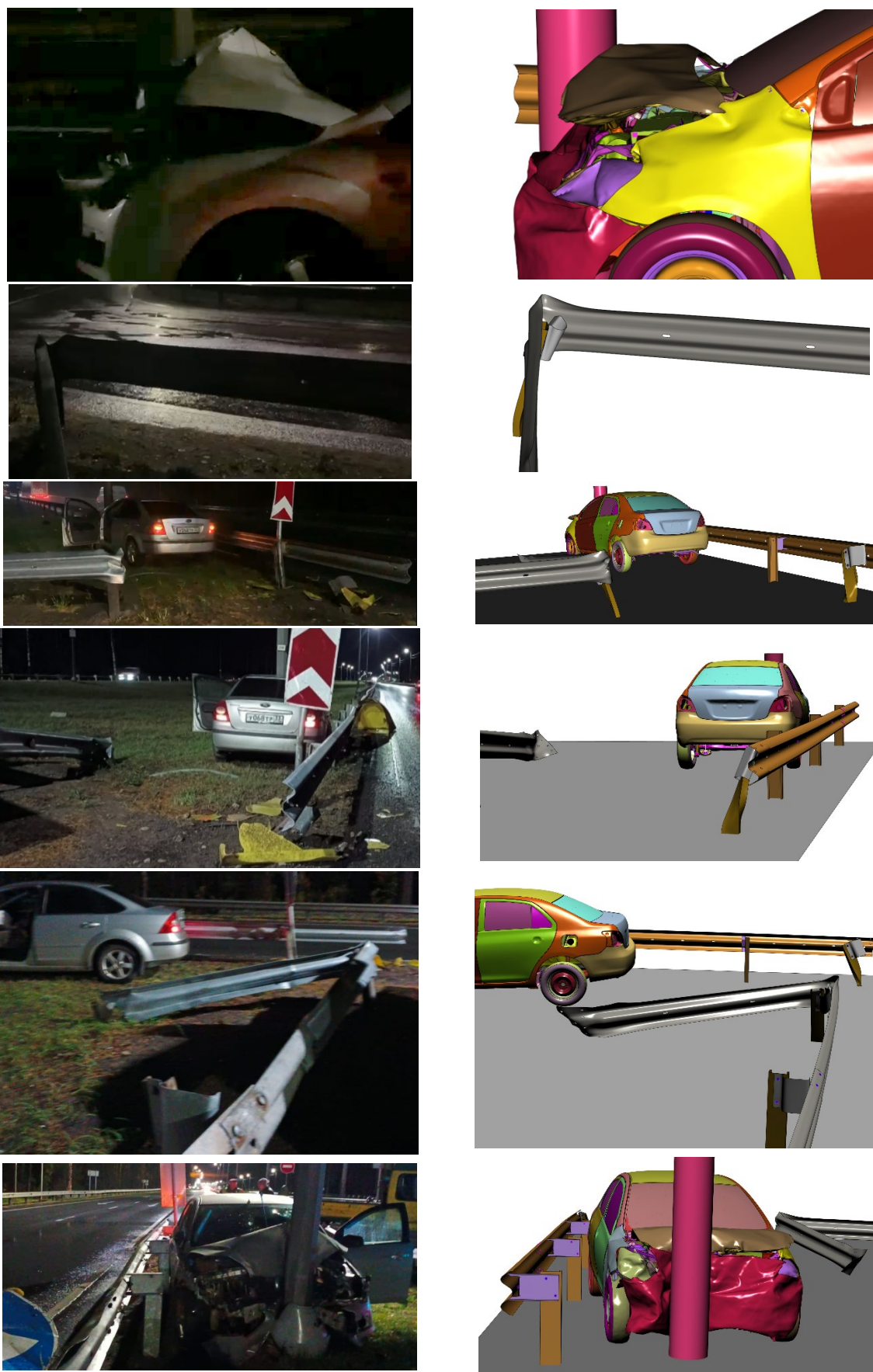
Рисунок Д.13 – Сравнение последствий реального ДТП (слева) и цифрового (справа)
