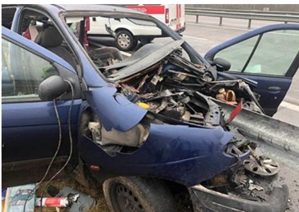
Рисунок Д.15 – Повреждения легкового автомобиля при наезде на торец барьерного ограждения
